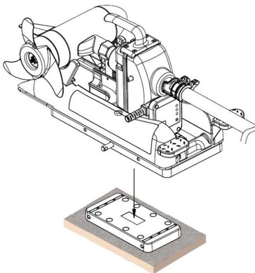
Installieren Sie den Sicherungsbügel, um die beiden Platten miteinander zu fixieren.
