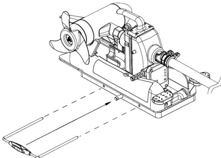
Tip: der mittlere Führungsstift hat ein Loch, um das Abheben des Motors durch ein Vorhängeschloss sichern zu können.
