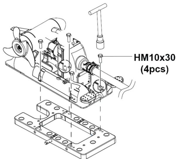
Die äußere Schnellwechselplatte mit dem angeschraubten Motor passt genau auf die innere Schnellwechselplatte
