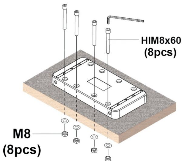
Der HASWING Cayman-B wird mit 4 beiliegenden Schrauben auf der Oberseite der äußeren Schnellwechselplatte verschraubt
