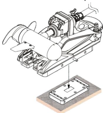
Installieren Sie den Sicherungsbügel, um die beiden Platten miteinander zu fixieren.
