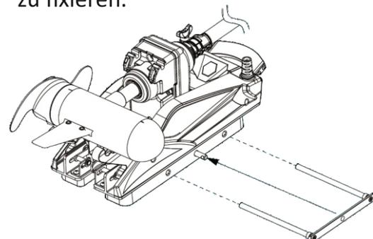
Tipp: der mittlere Führungsstift hat ein Loch, um das Abheben des Motors durch ein Vorhängeschloss sichern zu können.
