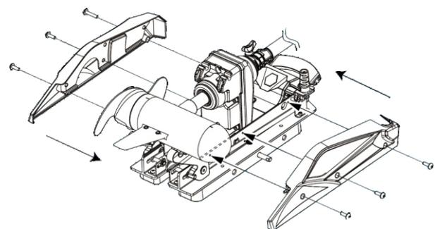
Die äußere Schnellwechselplatte mit dem angeschraubten Motor passt genau auf die innere Schnellwechselplatte
